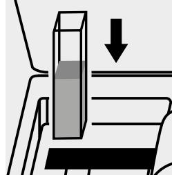
Küvette in den Küvetten-schacht einsetzen.
