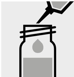
5,0 ml Probe in eine Reaktionsküvette pipettieren, **nicht mischen!**
