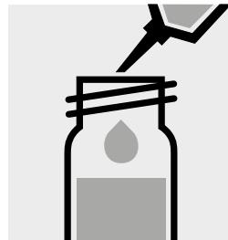
0,25 ml Cl-1K mit Pipette zugeben, mit Schraubkappe verschließen und mischen.
