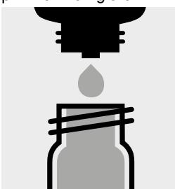
5 Tropfen O<sub>2</sub>-2K zugeben, mit Schraubkappe verschließen und 10 Sekunden mischen.
