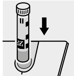
Küvette in den Küvetten-schacht einsetzen.
