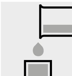
Lösung „**Messprobe**“ in die Kunststoff-Küvette geben.
