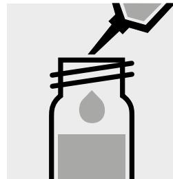
1,0 ml **Phosphorsäure 85 % z. A.** (Art. 1.00573) mit Pipette zugeben. Mit Schraubkappe verschließen und mischen.
