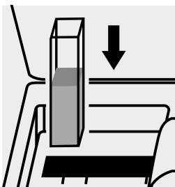
Küvette in den Küvetten- schacht einsetzen.
