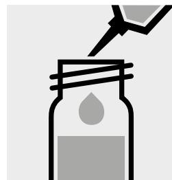
1,5 ml **vorbereitete Probe** mit Pipette sehr langsam zugeben, mit Schraubkappe verschließen und **kurz** mischen.
