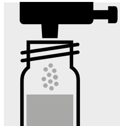
1 Dosis P-2K mit blauem Dosierer zugeben, mit Schraubkappe verschließen.
