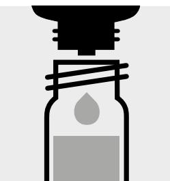
2 Tropfen Cl<sub>2</sub>-2 zugeben, mit Schraubkappe verschließen und mischen.
