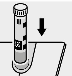
Küvette in den Küvetten- schacht einsetzen.
