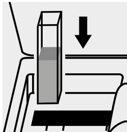
Küvette in den Küvetten- schacht einsetzen.
