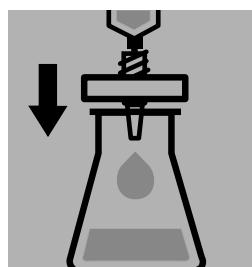
Extrakt **lichtgeschützt** über ein geeignetes Filter filtrieren.
