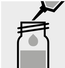
0,50 ml **Na-1K** in eine Reaktionsküvette pipettieren, mit Schraubkappe verschließen und mischen.
