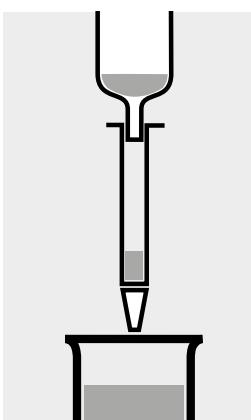
Verschlusshülse der Säule entfernen und Probe vollständig durchlaufen lassen.
