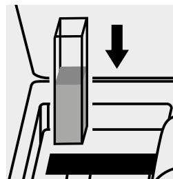
Küvette in den Küvetten- schacht einsetzen.
