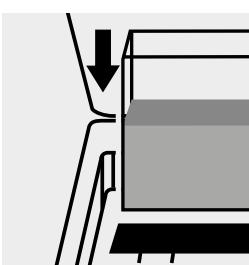
Proben-Küvette in den Küvettenschacht einsetzen.
