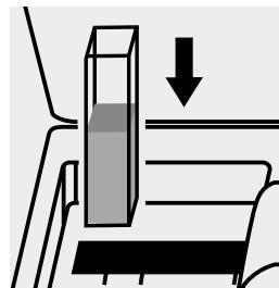
Küvette in den Küvetten-schacht einsetzen.
