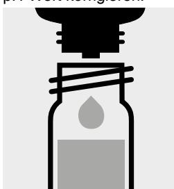
2 Tropfen **Cl<sub>2</sub>-3** zugeben, mit Schraubkappe verschließen und mischen.
