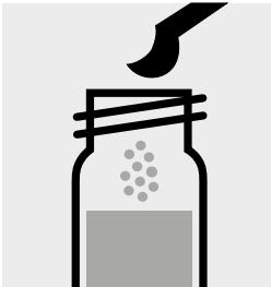
1 gestrichenen Mikro-löffel NO<sub>3</sub>-1K in eine Reaktionsküvette geben, mit Schraubkappe verschließen.
