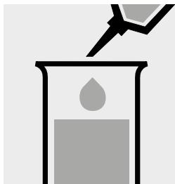
5,0 ml Probe in ein Reagenzglas pipettieren.
