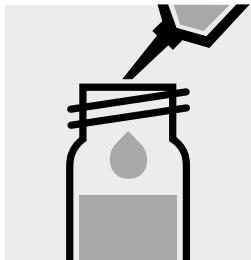
0,50 ml **Zn-2K** in eine Reaktionsküvette pipettieren, mit Schraubkappe verschließen und mischen.
