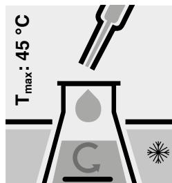
Zu beiden Erlenmeyerkolben je 25 ml **Schweifelsäure für CSB-Bestimmung** (Art. 1.17048) mit Glaspipette **unter Rühren und Kühlung langsam** zugeben.
