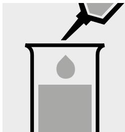
0,50 ml H<sub>2</sub>O<sub>2</sub>-2 mit Pipette zugeben und mischen.
