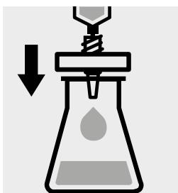
Probelösung durch Membranfilter Porenweite 0,45  $\mu\text{m}$  filtrieren.
