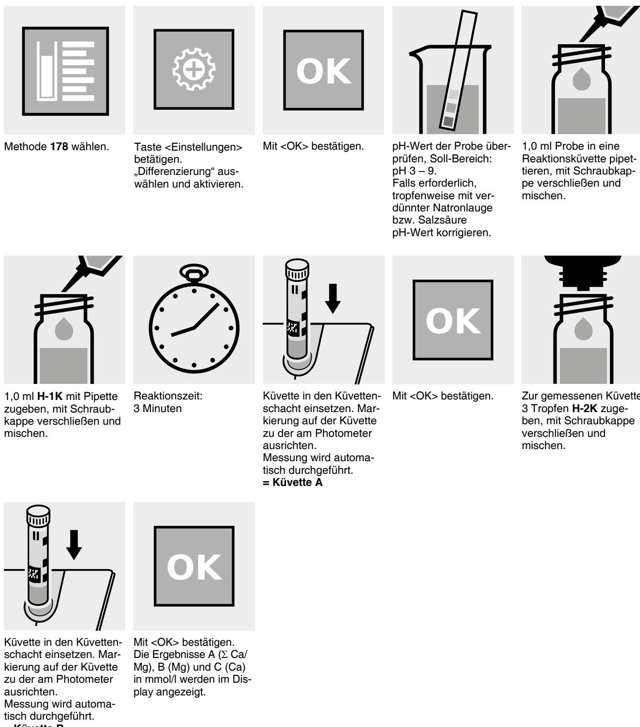
**Messbereich:** 0,5 – 12,0 mg/l Au      10-mm-Küvette
