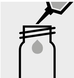
5,0 ml NO<sub>3</sub>-1 in eine trockene, leere Rundküvette (Leerküvetten, Art. 1.14724) pipettieren.
