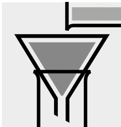
Bei Verunreinigungen Probe über ein Schnellfilterpapier filtrieren.
