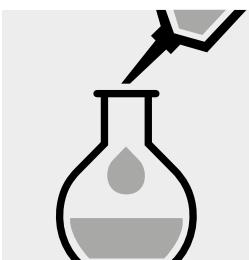
Messkolben mit **Schwefelsäure** 0,05 mol/l bis zur Marke auffüllen und gut mischen: **Lösung 1**.
