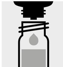
1 Tropfen Ag-4 zugeben, mit Schraubkappe verschließen und mischen.
