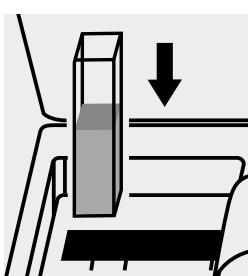
Küvette in den Küvetten- schacht einsetzen. Messung wird automatisch durchgeführt.
