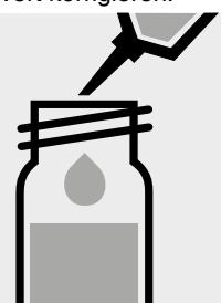
7,0 ml dest. Wasser in die zweite Reaktionsküvette pipettieren, mit Schraubkappe verschließen und mischen.
