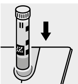
Küvette in den Küvetten-schacht einsetzen.
