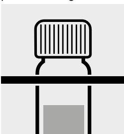
Küvette aus dem Thermoreaktor nehmen, im Reagenzglasgestell auf Raumtemperatur abkühlen lassen: **vorbereitete Probe**.
