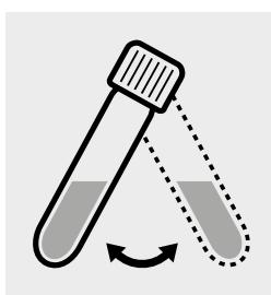
Küvette zum Lösen des Feststoffs umschwenken.
