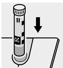
Küvette in den Küvetten-schacht einsetzen.
