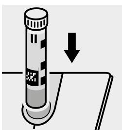
Küvette in den Küvetten-schacht einsetzen.
