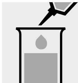
5,0 ml Probe in ein Reagenzglas pipettieren.
