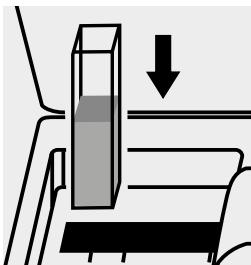
Küvette in den Küvetten- schacht einsetzen.
