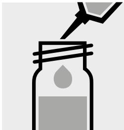
5,0 ml Probe in eine Reaktionsküvette pipettieren, mit Schraubkappe verschließen und mischen.
