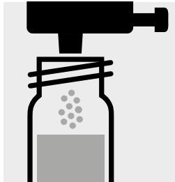
1 Dosis **CN-1K** mit grünem Dosierer zugeben, mit Schraubkappe verschließen.
