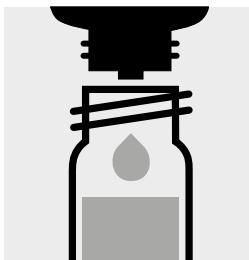
2 Tropfen **Reagenz 2** zugeben, mit Schraubkappe verschließen und mischen.
