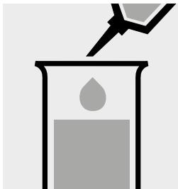
8,0 ml Probe in ein Reagenzglas pipettieren.
