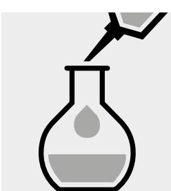
Messkolben bis zur Marke mit **Cyclohexan für die Spektroskopie Uvasol®** (Art. 1.02822) auffüllen und mischen.
