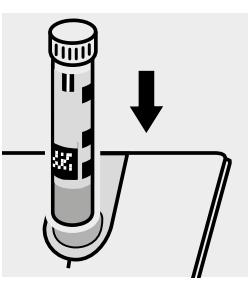
Proben-Küvette in den Küvettenschacht einsetzen. Markierung auf der Küvette zu der am Photometer ausrichten.
