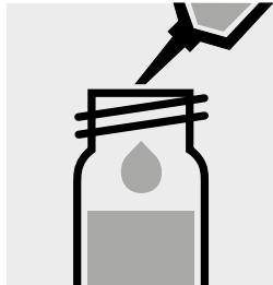
Zu beiden Gefäßen je 0,10 ml **Si-1** mit Pipette zugeben, mit Schraubkappe verschließen und mischen.
