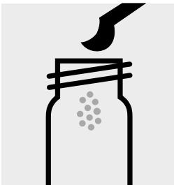
1 gestrichenen Mikro-löffel NO<sub>3</sub>-1 in eine trockene, leere Rundküvette (Leerküvette, Art. 1.14724) geben.
