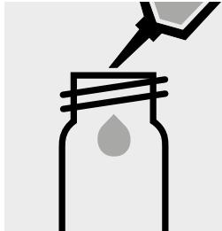
10 ml dest. Wasser (empfohlen wird Art. 1.01262, Wasser Ultrapur) in ein zweites Kunststoffgefäß (**Flachbodengläser, Art. 1.17988**) pipettieren. (Blindwert)
