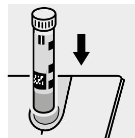
**Küvette A** in den Küvettenschacht einsetzen. Markierung auf der Küvette zu der am Photometer ausrichten. Messung wird automatisch durchgeführt.
