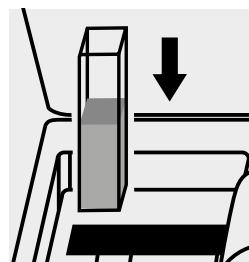
Küvette in den Küvetten-schacht einsetzen.
