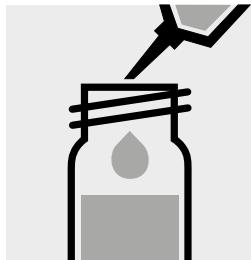
0,25 ml Al-2K mit Pipette zugeben, mit Schraubkappe verschließen und mischen.
