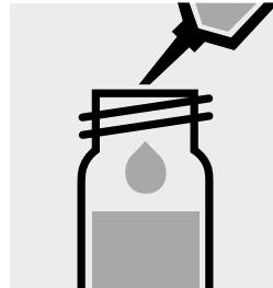
1,5 ml Probe mit Pipette sehr langsam zugeben, mit Schraubkappe verschließen und **kurz** mischen.
