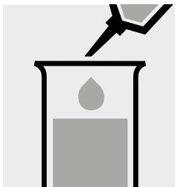
5,0 ml Probe in ein Reagenzglas pipettieren.
