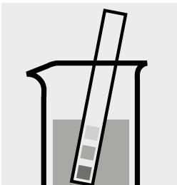
pH-Wert der Probe überprüfen, Soll-Bereich: pH 0–10. Falls erforderlich, tropfenweise mit verdünnter Schwefelsäure pH-Wert korrigieren.
