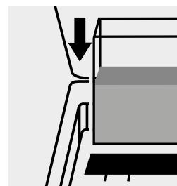
Blindwert-Küvette in den Küvettenschacht einsetzen.
