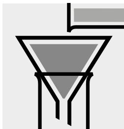
Bei Verunreinigungen Probe über ein Schnellfilterpapier filtrieren.
