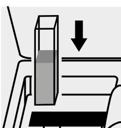
Küvette in den Küvetten- schacht einsetzen.
