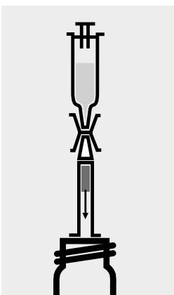
An das untere Ende der Säule Verbindungsstück aufsetzen. Kohle in der Säule mit 10 ml **AOX-5** mittels Kunststoffspritze in eine leere Rundküvette spülen.
