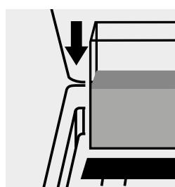
Küvette in den Küvetten-schacht einsetzen.
