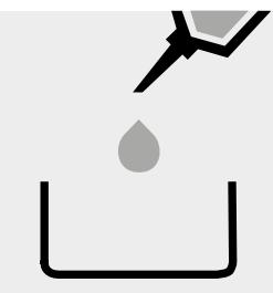
25,0 ml Probe in eine Platinschale pipettieren und eine Veraschung gemäß EN 1136 [3] durchführen.
