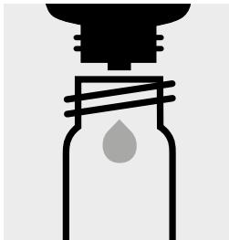
6 Tropfen **Cr-3K** in eine Reaktionsküvette geben, mit Schraubkappe verschließen.
