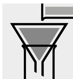
Gesamte Mischung über ein hydrophobes Filter gemäß EN 1141 [1] bzw. §64 LFGB 31.00-7 [2] filtrieren:
