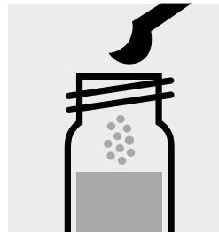
Je 1 gestrichenen grauen Mikrolöffel **SO<sub>3</sub>-1K** in zwei Reaktionsküvetten geben, mit Schraubkappe verschließen.
