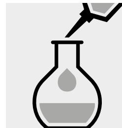
Messkolben bis zur Marke mit dest. Wasser (empfohlen wird Art. 1.16754, Wasser zur Analyse EMSURE®) auffüllen und mischen.
