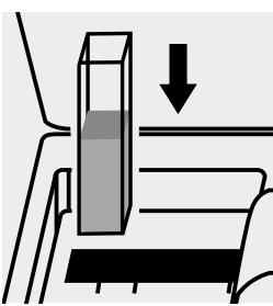
Küvette in den Küvetten-schacht einsetzen.
