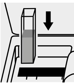
Küvette in den Küvetten-
