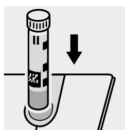
Küvette in den Küvettenschacht einsetzen.
