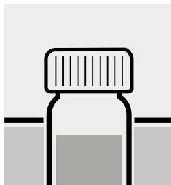
Gefäß im Wasserbad **genau** 5 Minuten bei  $95 \pm 5$  °C temperieren.
