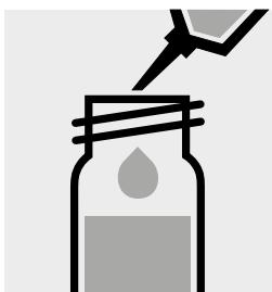
5,0 ml Probe in ein Glas mit Schraubverschluss pipettieren.
