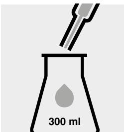
20 ml dest. Wasser (empfohlen wird Art. 1.15333, Wasser für die Chromatographie LiChrosolv®) mit Glaspipette in einen zweiten 300-ml-Erlenmeyerkolben mit NS 29/32 geben.
