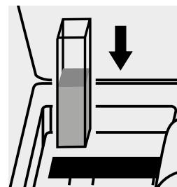
Küvette in den Küvetten-schacht einsetzen.
