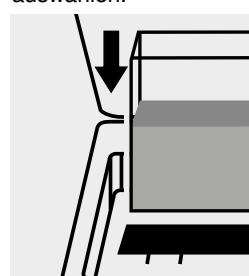
Proben-Küvette in den Küvettenschacht einsetzen.
