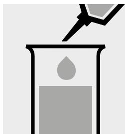
5,0 ml dest. Wasser und 0,50 ml Probe mit Pipette zugeben und mischen.
