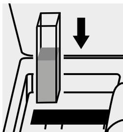
Küvette in den Küvetten- schacht einsetzen.
