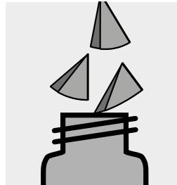
Filterteile in ein Extraktionsgefäß (**lichtgeschützt**) geben.
