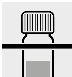
Küvette aus dem Thermoreaktor nehmen, im Reagenzglasgestell abkühlen lassen.
