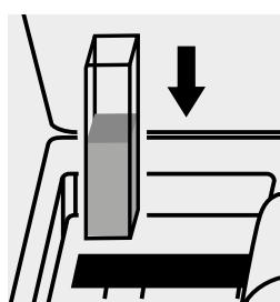
Blindwert-Küvette in den Küvettenschacht einsetzen.
