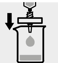
10 - 20 ml vorbereitete Lösung über ein Membranfilter in ein sauberes, trockenes Becherglas filtrieren.
