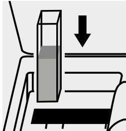
Küvette in den Küvetten- schacht einsetzen.
