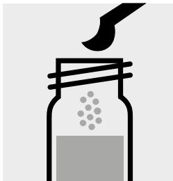
Ca. 1,5 g **Aluminiumchlorid-Hexahydrat reinst.** (Art. 1.01084) zugeben, mit Schraubkappe verschließen.
