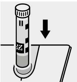
Küvette in den Küvetten- schacht einsetzen.
