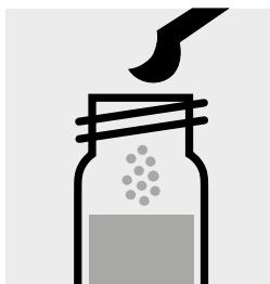
1 gestrichenen Mikrolöffel N-3K in eine Reaktionsküvette geben, mit Schraubkappe verschließen.
