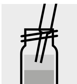
Mit Pasteurpipette organische, klare obere Schicht abziehen und über **Natriumsulfat wasserfrei z. A.** (Art. 1.06649) trocknen.
