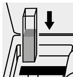
Küvette in den Küvetten- schacht einsetzen.
