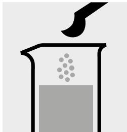
1 gestrichenen grauen Mikrolöffel **Zn-1K** zugeben und Feststoff lösen:
