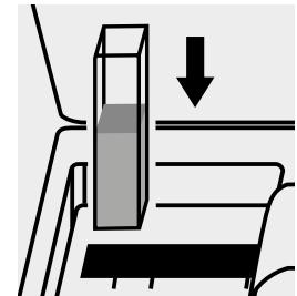
Küvette in den Küvetten-schacht einsetzen.
