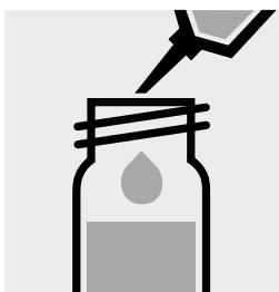
1,0 ml **OA-4K** mit Pipette zugeben, mit Schraubkappe verschließen und kräftig schütteln.
