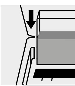
Proben-Küvette in den Küvettenschacht einsetzen.
