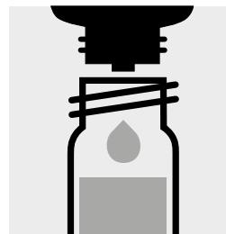
2 Tropfen **Reagenz 3** zugeben, mit Schraubkappe verschließen und mischen.
