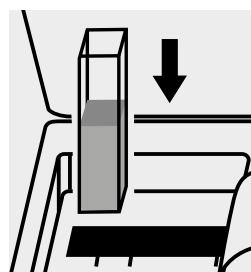
Küvette in den Küvetten- schacht einsetzen.
