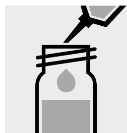
2 ml **Farbreagenz** zugeben, mit Schraubkappe verschließen und mischen.
