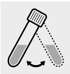
Bodensatz in Küvette durch Umschwenken in Schwebeflüssigkeit bringen.
