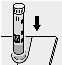
Küvette in den Küvetten-schacht einsetzen.
