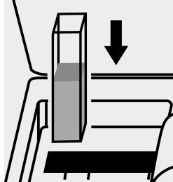
Küvette in den Küvetten- schacht einsetzen.
