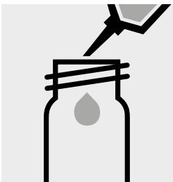
5,0 ml Probe in eine Reaktionsküvette pipettieren, mit Schraubkappe verschließen und Feststoff lösen.
