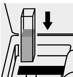
Küvette in den Küvetten-schacht einsetzen.
