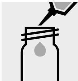
5,0 ml **vorbereitete Probe** in eine Reaktionsküvette pipettieren, mit Schraubkappe verschließen und Feststoff lösen.
