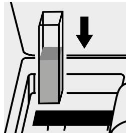
Küvette in den Küvetten- schacht einsetzen.
