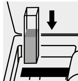
Küvette in den Küvetten-schacht einsetzen.
