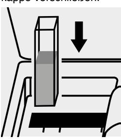
Küvette in den Küvetten-schacht einsetzen.
