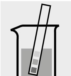
pH-Wert der Probe überprüfen, Soll-Bereich: pH 2 – 5. Falls erforderlich, tropfenweise mit verdünnter Natronlauge bzw. Schwefelsäure pH-Wert korrigieren.
