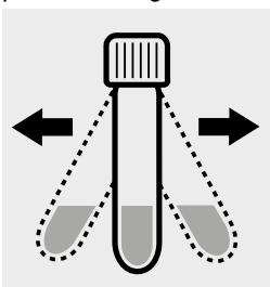
Küvetten zum Lösen des Feststoffs kräftig schütteln.
