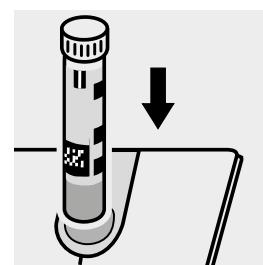
Küvette in den Küvetten-schacht einsetzen. Markierung auf der Küvette zu der am Photometer ausrichten.
