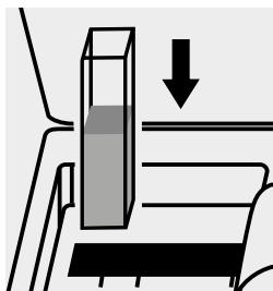
Küvette in den Küvetten- schacht einsetzen.
