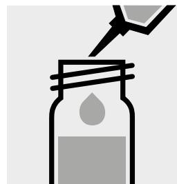
0,100 ml dest. Wasser (empfohlen wird Art. 1.16754, Wasser zur Analyse EMSURE®) in ein Glas mit Schraubverschluss pipettieren.
