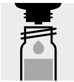
Filtrat mit 4 Tropfen SO<sub>4</sub>-4 versetzen, mit Schraubkappe verschließen und mischen.
