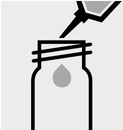
5,0 ml der 1:4 verdünnten Probe in eine leere Rundküvette (Leerküvetten, Art. 1.14724) pipettieren.
