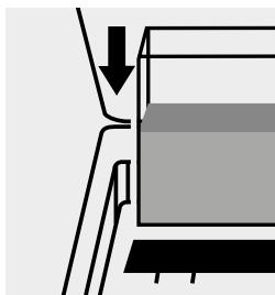
Küvette in den Küvetten- schacht einsetzen.
