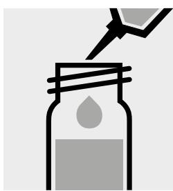
1,0 ml OA-5 mit Pipette zugeben, mit Schraubkappe verschließen und kräftig schütteln.
