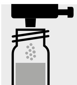
1 Dosis P-3K mit blauem Dosierer zugeben, mit Schraubkappe verschließen.
