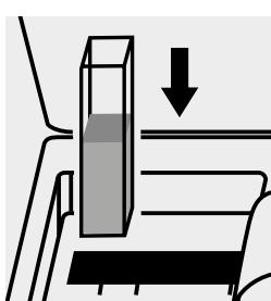
Küvette in den Küvetten-schacht einsetzen.
