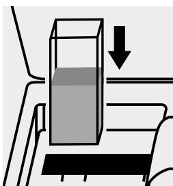
Küvette in den Küvetten- schacht einsetzen.
