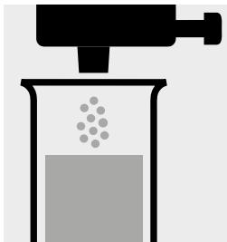
1 Dosis Fe-3 mit blauem Dosierer zugeben und Feststoff lösen.
