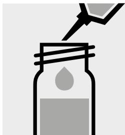
2,0 ml **DNSA-Reagenz** mit Pipette zugeben, verschließen und mischen.
