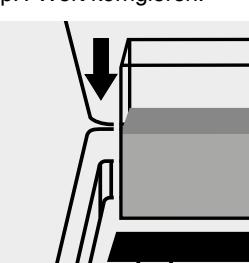
Küvette in den Küvetten- schacht einsetzen.
