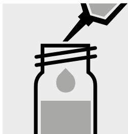
0,50 ml NO<sub>3</sub>-2 mit Pipette zugeben, mit Schraubkappe verschließen und mischen.
