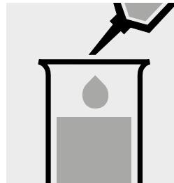
5,0 ml Probe mit Pipette zugeben und mischen.
