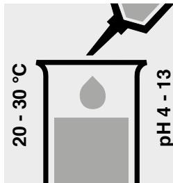
5,0 ml Probe in ein Reagenzglas pipettieren. Falls erforderlich, tropfenweise mit verdünnter Natronlauge bzw. Schwefelsäure pH-Wert korrigieren bzw. Probe temperieren.
