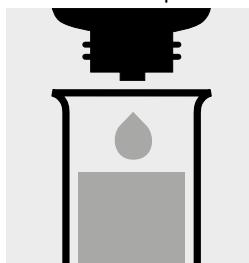
4 Tropfen NH<sub>4</sub>-3 (aus Spectroquant® Ammonium-Test, Art. 1.14752) zugeben und mischen.
