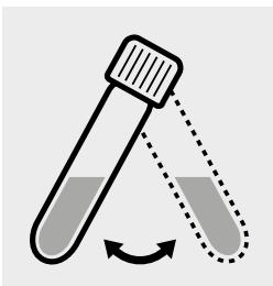
Bodensatz in zwei Küvetten durch Umschwenken in Schwebeflüssigkeit bringen.
