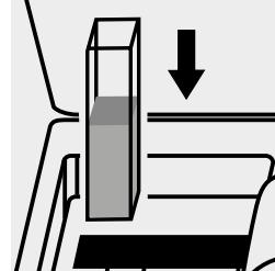
Küvette in den Küvetten-schacht einsetzen.
