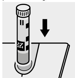
Küvette in den Küvetten- schacht einsetzen.
