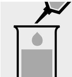
5,0 ml Probe in ein Reagenzglas pipettieren.
