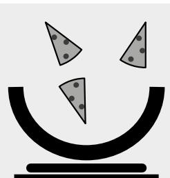
Etwa 5 g zerkleinerten Käse auf 1 mg genau in eine Reibschale einwiegeln.
