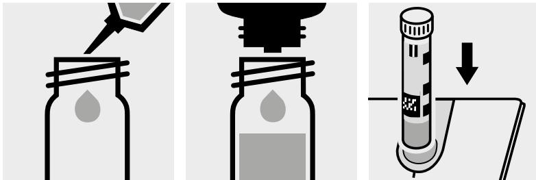
10 ml Probe in eine Rundküvette pipettieren.
