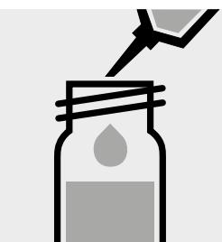
2 ml **Farbreagenz** zugeben, mit Schraubkappe verschließen und mischen.
