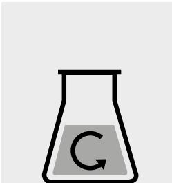
Unfiltrierte Probelösung aufschütteln, um Trübstoffe gleichmäßig zu verteilen. Inhaltsstoffe nicht dispergieren.
