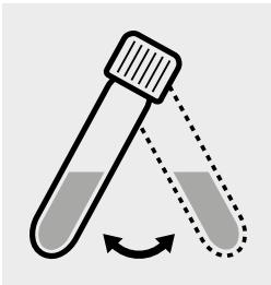
Bodensatz in Küvette durch Umschwenken in Schweben bringen.
