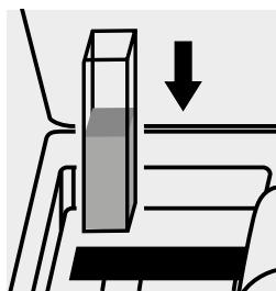
Küvette in den Küvetten- schacht einsetzen.
