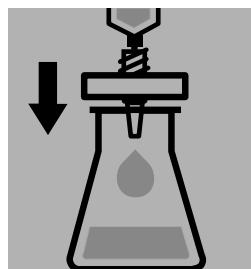
Extrakt **lichtgeschützt** über ein geeignetes Filter filtrieren.
