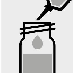
Zu beiden Gefäßen je 0,50 ml **Si-3** mit Pipette zugeben, mit Schraubkappe verschließen und mischen.
