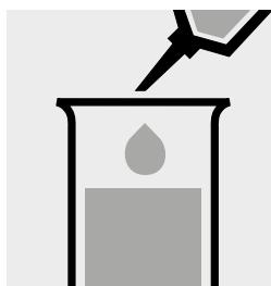
In ein Reagenzglas 10 ml Probe mit Pipette zugeben und mischen.
