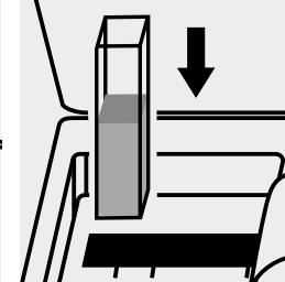
Küvette in den Küvetten- schacht einsetzen.
