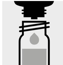
2 Tropfen **Reagenz 1** zugeben, mit Schraubkappe verschließen und mischen.
