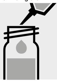
2,5 ml SO<sub>4</sub>-3 mit Pipette zugeben, mit Schraubkappe verschließen und mischen.
