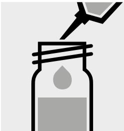
1,0 ml Probe in eine Reaktionsküvette pipettieren, mit Schraub- kappe verschließen und mischen.
