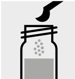
1 gestrichenen grauen Mikrolöffel SO<sub>3</sub>-1K in eine Reaktionsküvette geben, mit Schraubkappe verschließen.
