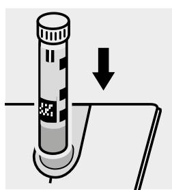
Küvette in den Küvetten-schacht einsetzen. Markierung auf der Küvette zu der am Photometer ausrichten.
