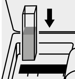
Küvette in den Küvetten- schacht einsetzen.
