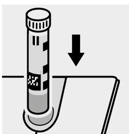
Küvette in den Küvetten- schacht einsetzen.
