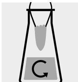
Bei Raumtemperatur für 2 Stunden bei 250 U/min rühren lassen:
