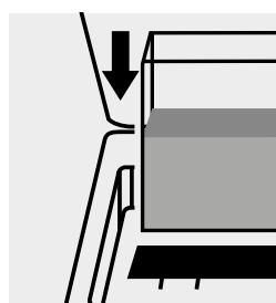
Blindwert-Küvette in den Küvettenschacht einsetzen.
