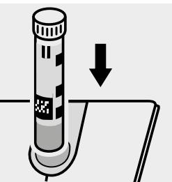
Küvette in den Küvetten- schacht einsetzen.
