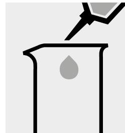
20 ml dest. Wasser (empfohlen wird Art. 1.16754, Wasser zur Analyse EMSURE®) in ein zweites geeignetes Gefäß geben. (Blindwert)
