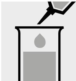
5,0 ml Probe in ein Reagenzglas pipettieren.
