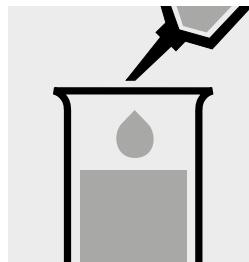
0,50 ml PO<sub>4</sub>-1 mit Pipette zugeben und mischen.
