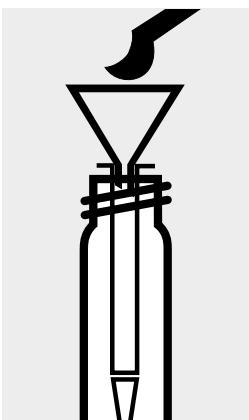
Säule in eine leere Rundküvette stellen, Glastrichter aufsetzen, 1 gestrichenen blauen Mikrolöffel **AOX-1** einfüllen.
