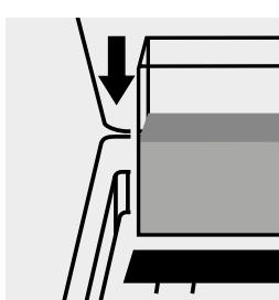
Blindwert-Küvette in den Küvettenschacht einsetzen.
