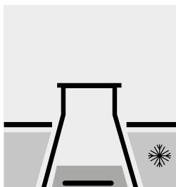
Je einen Magnetrührstab zugeben und im Eisbad kühlen.
