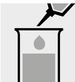
2 ml dest. Wasser (empfohlen wird Art. 1.16754, Wasser zur Analyse EMSURE®) mit 8 ml **Reagenzlösung** mischen: **Reagenzienblindwert**.
