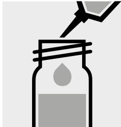
0,10 ml Probe **vorsichtig** in eine Reaktionsküvette pipettieren, mit Schraubkappe fest verschließen und kräftig mischen.
