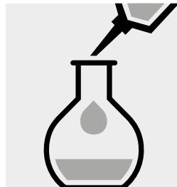
1,0 ml **Reagenz 3** mit Pipette zugeben, mit destilliertem Wasser bis zur Marke auffüllen und gut mischen.
