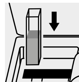
Küvette in den Küvetten-schacht einsetzen.
