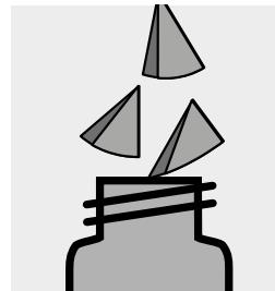
Filterteile in ein Extraktionsgefäß (**lichtgeschützt**) geben.
