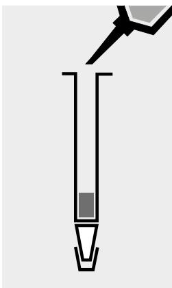
Säule unten verschließen. 1 ml **AOX-3** aufgeben. Säule oben verschließen und umschwenken, um Luftblasen zu entfernen. Säule oben öffnen und bis zum Rand mit **AOX-3** füllen.
