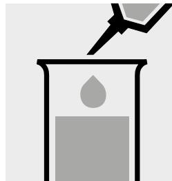
0,60 ml NH<sub>4</sub>-1 (aus Spectroquant® Ammonium-Test, Art. 1.14752) mit Pipette zugeben und mischen.
