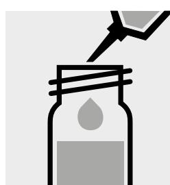
2,0 ml **Ethylenglycol-monomethylether** zugeben, mit Schraubkappe verschließen und mischen.
