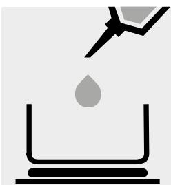
Probe auf 1 mg genau in ein geeignetes Gefäß einwiegen und einen Nassaufschluss bzw. eine Veraschung gemäß §64 LFGB 01.00-92 [1] durchführen.
