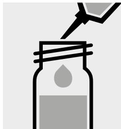
1,0 ml **vorbereitete Probe** in eine Reaktionsküvette pipettieren, **nicht mischen**.
