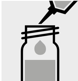
4,0 ml Probe in eine Reaktionsküvette pipettieren, mit Schraubkappe verschließen und mischen.
