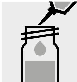
1,0 ml NO<sub>3</sub>-1K mit Pipette zugeben, mit Schraubkappe verschließen und mischen. **Vorsicht, Küvette wird heiß!**
