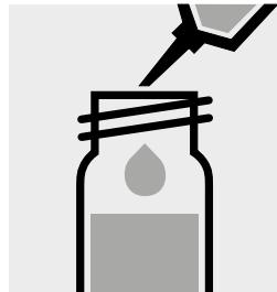
10 ml dest. Wasser in eine zweite Reaktionsküvette pipettieren, mit Schraubkappe verschließen und mischen.
