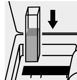
Küvette in den Küvetten-schacht einsetzen.
