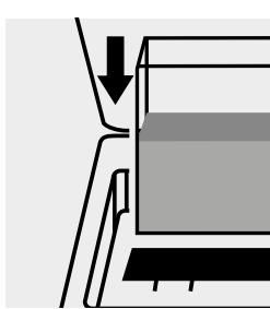
Küvette in den Küvetten- schacht einsetzen. Messung wird automatisch durchgeführt.
