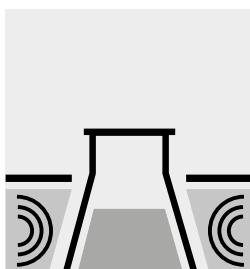
Probe im Ultraschall-Bad entgasen.
