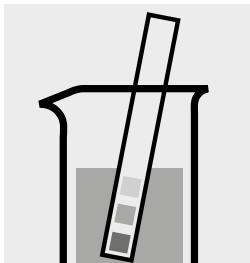
pH-Wert der Probe überprüfen, Soll-Bereich: pH 2–10. Falls erforderlich, tropfenweise mit verdünnter Schwefelsäure pH-Wert korrigieren.
