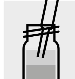
Mit Pasteurpipette organische, klare obere Schicht abziehen und über **Natriumsulfat wasserfrei z. A.** (Art. 1.06649) trocknen.
