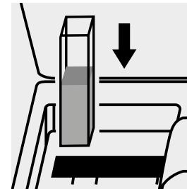
Küvette in den Küvetten-schacht einsetzen.
