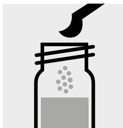
1 gestrichenen blauen Mikrolöffel **CN-3K** zugeben, mit Schraubkappe verschließen.
