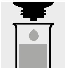
1 Tropfen Ni-1 zugeben und mischen. Bei Entfärbung der Lösung ist die Dosierung des Reagenzes tropfenweise zu erhöhen, bis eine schwache Gelbfärbung bestehen bleibt.
