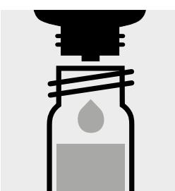
5 Tropfen **AOX-4** zugeben, mit Schraubkappe verschließen und mischen. Kohle absitzen lassen; überstehende Lösung: vorbereitete Probe.
