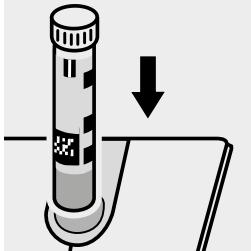
Küvette in den Küvetten- schacht einsetzen.
