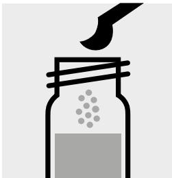
1 gestrichenen grünen Mikrolöffel SO<sub>4</sub>-2 zugeben, mit Schraubkappe verschließen und mischen.
