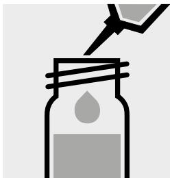
3,0 ml **abgericherte Probe** vorsichtig in eine Reaktionsküvette pipettieren, mit Schraubkappe fest verschließen und kräftig mischen.
