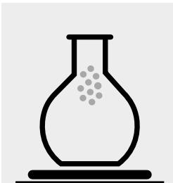
Puverisierte Probe auf 0,1 mg genau in einen Messkolben einwiegen.
