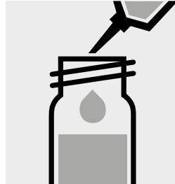
5,0 ml **Isobutymethylketon z. A.** (Art. 1.06146) mit Pipette zugeben, mit Schraubkappe verschließen.
