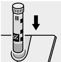
Küvette in den Küvetten- schacht einsetzen.
