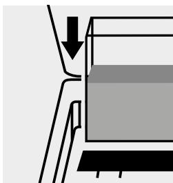
Blindwert-Küvette in den Küvettenschacht einsetzen.
