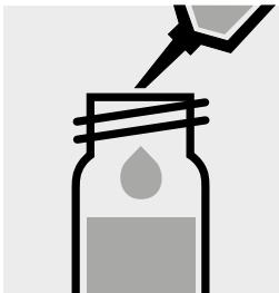
5,0 ml dest. Wasser (empfohlen wird Art. 1.16754, Wasser zur Analyse EMSURE®) in eine zweite Reaktionsküvette pipettieren, mit Schraubkappe verschließen und mischen. (Blindwert)
