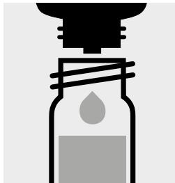
5 Tropfen P-2K zugeben, mit Schraubkappe verschließen und mischen.
