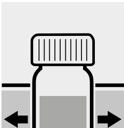
Glas im Wasserbad 5 Minuten bei 40 °C temperieren.
