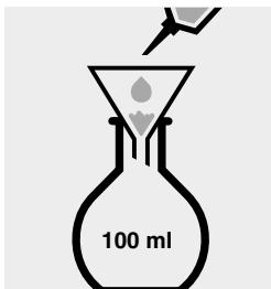
Probe mit etwa 80 ml dest. Wasser (empfohlen wird Art. 1.16754, Wasser zur Analyse EMSURE®) in einen 100-ml-Messkolben überspülen.
