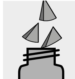
Filterteile in ein Extraktionsgefäß (**lichtgeschützt**) geben.
