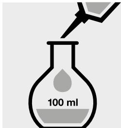
4,0 ml der verdünnten Probe in einen 100 ml Messkolben pipettieren, mit destilliertem Wasser bis zur Marke auffüllen und gut mischen.
