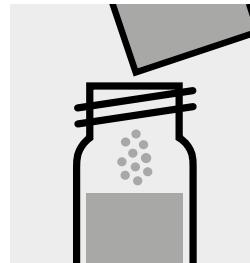
1 Pulverpäckchen **Molybdenum HR3** zugeben und mit Schraubkappe verschließen.
