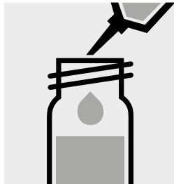
3,0 ml Probe mit Pipette zugeben, mit Schraubkappe verschließen und mischen.
