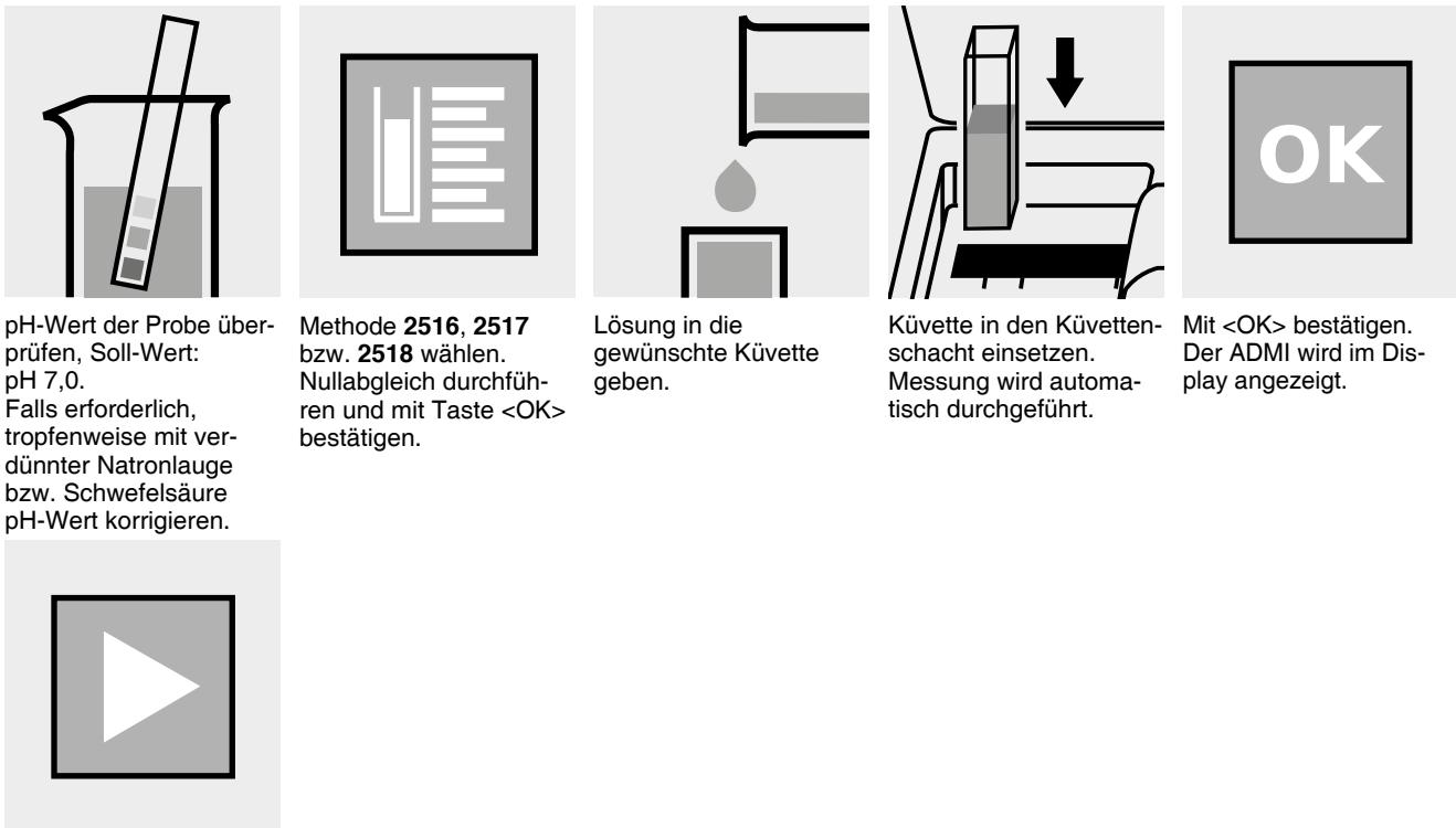
pH-Wert der Probe überprüfen, Soll-Wert: pH 7,0. Falls erforderlich, tropfenweise mit verdünnter Natronlauge bzw. Schwefelsäure pH-Wert korrigieren.
