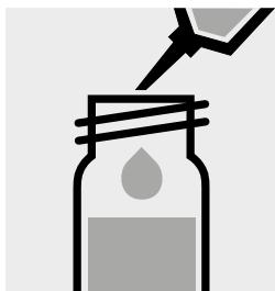
5,0 ml Probe mit Pipette zugeben, mit Schraubkappe verschließen.
