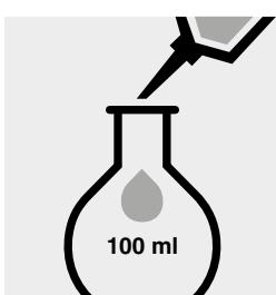
Passendes Volumen der vorbereiteten Probelösung auf 0,1 ml genau in einen 100-ml-Messkolben pipettieren.
