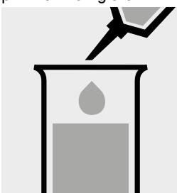
2,0 ml Probe mit Pipette zugeben und mischen.
