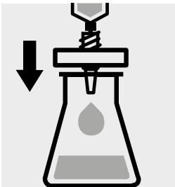
Probelösung durch Membranfilter Porenweite 0,45 µm filtrieren.
