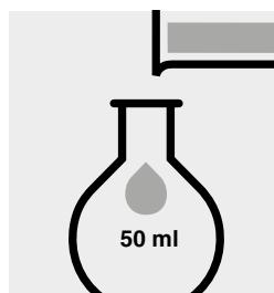
Lösung in einen 50-ml-Messkolben überführen.
