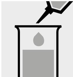
5,0 ml Probe in ein Reagenzglas pipettieren.
