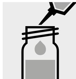
5,0 ml **Toluol z. A.** (Art. 1.08325) mit Pipette zugeben, mit Schraubkappe verschließen.
