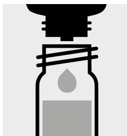
3 Tropfen **Cl<sub>2</sub>-2** zugeben, mit Schraubkappe verschließen und mischen.
