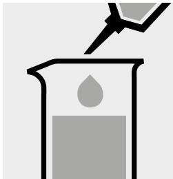
10 ml Probe in ein Glasgefäß pipettieren.
