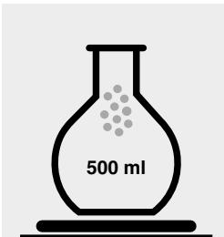
Puverisierte Probe auf 0,1 mg genau in einen 500-ml-Messkolben einwiegen.
