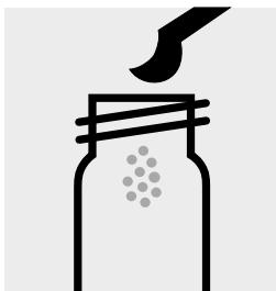
In eine Reaktionsküvette 2 gestrichene blaue Mikrolöffel **NO<sub>2</sub>-1K** zugeben.
