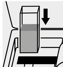
Küvette in den Küvetten- schacht einsetzen.
