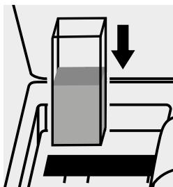
Küvette in den Küvetten- schacht einsetzen.
