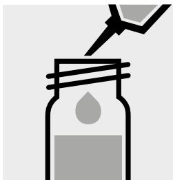
0,20 ml **Reagenz 2** mit Pipette zugeben. Mit Schraubkappe verschließen und mischen.
