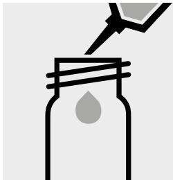
4,0 ml der Probe in eine leere Rundküvette (Leerküvetten, Art. 114724) pipettieren.
