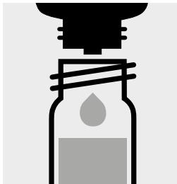
3 Tropfen **Mg-2K** zugeben, mit Schraubkappe verschließen und mischen.
