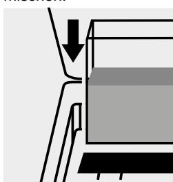
Blindwert-Küvette in den Küvettenschacht einsetzen.
