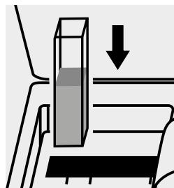
Küvette in den Küvetten- schacht einsetzen.
