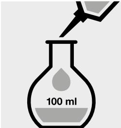
25 ml der Probe in einen 100 ml Messkolben pipettieren, mit destilliertem Wasser bis zur Marke auffüllen und gut mischen.
