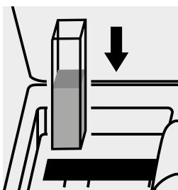
Küvette in den Küvetten-schacht einsetzen.
