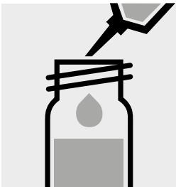
0,50 ml Probe in eine Reaktionsküvette pipettieren, **nicht mischen**.
