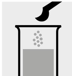
1 gestrichenen blauen Mikrolöffel NH<sub>4</sub>-2 (aus Spectroquant® Ammonium-Test, Art. 1.14752) zugeben.
