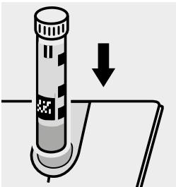
Küvette in den Küvetten- schacht einsetzen.
