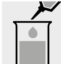
0,50 ml SO<sub>4</sub>-1 in ein Reagenzglas pipettieren.
