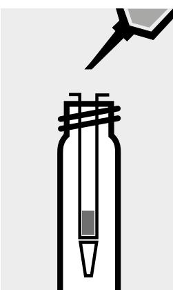
Säule vom Reservoir trennen, 3 x je 1 ml **AOX-3** vollständig durch die Säule laufen lassen. Waschlösung verwerfen.
