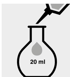
10 ml **Natriummolybdat/Ascorbinsäure-Reagenz** in einen 20-ml-Messkolben geben.
