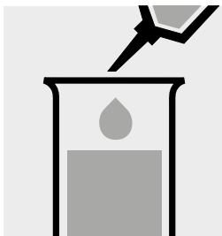
5,0 ml Probe in ein Reagenzglas pipettieren.
