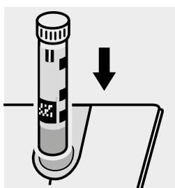
Küvette in den Küvetten-schacht einsetzen.
