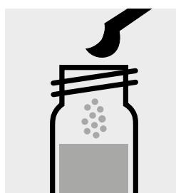
2 gestrichene grüne Mikrolöffel **AOX-6** zugeben, Küvette mit Schraubkappe fest verschließen und mischen.
