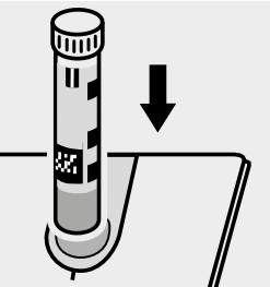
Küvette in den Küvetten- schacht einsetzen.
