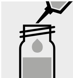
1,0 ml NO<sub>3</sub>-1K in eine Reaktionsküvette pipettieren, **nicht mischen**.
