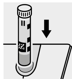
**Küvette PO<sub>4</sub>-P** in den Küvettenschacht ein-setzen. Markierung auf der Küvette zu der am Photometer ausrichten. Messung wird automa-tisch durchgeführt.
