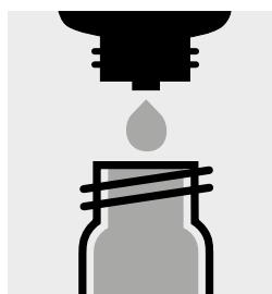
10 Tropfen O<sub>2</sub>-3K zugeben, Küvette verschließen, mischen und von außen säubern.
