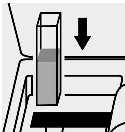
Küvette in den Küvetten- schacht einsetzen.
