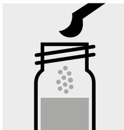
1 gestrichenen blauen Mikrolöffel CN-1K zugeben, mit Schraubkappe verschließen.
