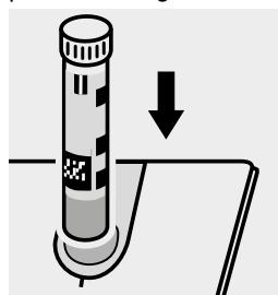
Küvette in den Küvetten- schacht einsetzen.
