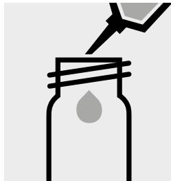
5,0 ml der 1:500 verdünnten Probe in eine leere Rundküvette (Leerküvetten, Art. 1.14724) pipettieren.
