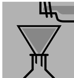
Extrakt **lichtgeschützt** über ein Papierfilter (Blauband) in einen Messkolben (bei DIN 38412: 100 ml) filtrieren. Filter mit wenig Ethanol nachwaschen.
