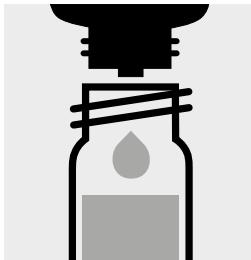
5 Tropfen **Zn-1K** in eine Reaktionsküvette geben, mit Schraubkappe verschließen und mischen.
