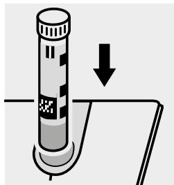
Küvette in den Küvetten- schacht einsetzen. Markierung auf der Küvette zu der am Photometer ausrichten.
