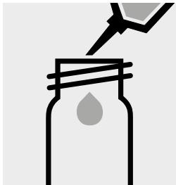
10 ml Probe in eine leere Rundküvette (Leerküvetten, Art. 1.14724) pipettieren.
