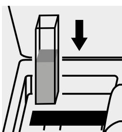
Küvette in den Küvetten-
