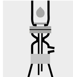
Vorbereitete Lösung unter Vakuum über ein Membranfilter in einen sauberen, trockenen Erlenmeyerkolben filtrieren.
