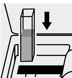
Proben-Küvette in den Küvettenschacht einsetzen.
