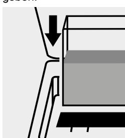
Blindwert-Küvette in den Küvettenschacht einsetzen.
