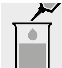
0,50 ml Probe in ein Reagenzglas pipettieren.
