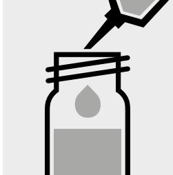
Zu beiden Gefäßen je 0,10 ml **Si-2** mit Pipette zugeben, mit Schraubkappe verschließen und mischen.
