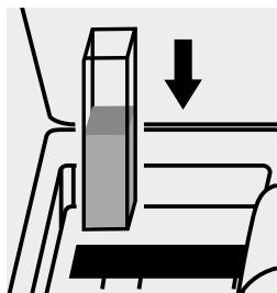
Küvette in den Küvetten- schacht einsetzen.
