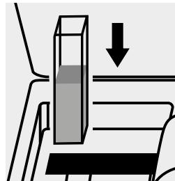
Küvette in den Küvetten- schacht einsetzen.
