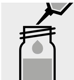
5,0 ml Probe in eine Reaktionsküvette geben, **nicht mischen!**
