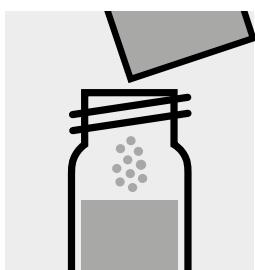
1 Pulverpäckchen **Oxyscav 1** zugeben und mit Schraubkappe verschließen.
