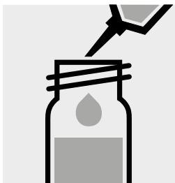
1,0 ml Probe mit Pipette zugeben. **Vorsicht, Küvette wird heiß!**
