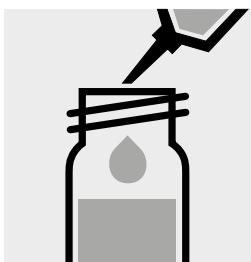
1,0 ml **OA-3K** mit Pipette zugeben, mit Schraubkappe verschließen und mischen.
