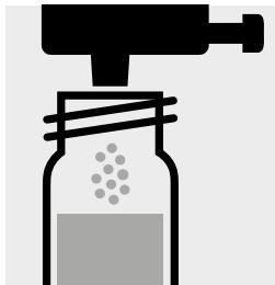
1 Dosis PO<sub>4</sub>-2K mit blauem Dosierer zugeben, mit Schraubkappe verschließen.
