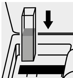
Küvette in den Küvetten- schacht einsetzen.
