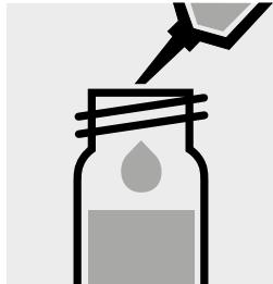
10 ml Probe mit Pipette zugeben, mit Schraubkappe verschließen.
