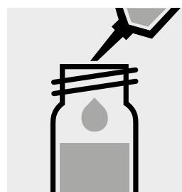
0,20 ml **Oxyscav 2** mit Pipette zugeben, mit Schraubkappe verschließen und mischen.
