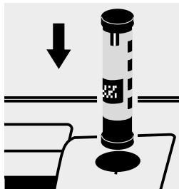
Mit AutoSelector Messbereich 5–150 mg/l NH<sub>4</sub>-N Methode wählen.
