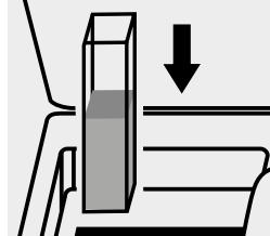
Küvette in den Küvetten- schacht einsetzen. Messung wird automatisch durchgeführt.
