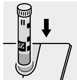
**Küvette A** in den Küvettenschacht einsetzen. Markierung auf der Küvette zu der am Photometer ausrichten. Messung wird automatisch durchgeführt.
