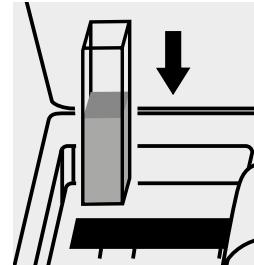
Küvette in den Küvetten-schacht einsetzen.
