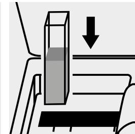
Küvette in den Küvetten- schacht einsetzen.
