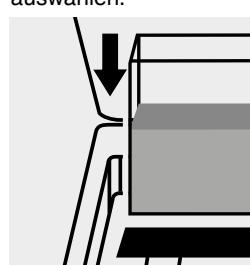
Proben-Küvette in den Küvettenschacht einsetzen.
