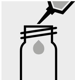
5,0 ml Probe in eine Reaktionsküvette pipettieren, mit Schraubkappe verschließen.
