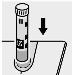
Küvette in den Küvetten- schacht einsetzen.
