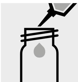
5,0 ml vorbereite Probe in eine leere Rundküvette (Leerküvetten, Art. 1.14724) pipettieren.
