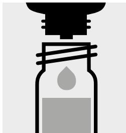
3 Tropfen Ag-3 zugeben, mit Schraubkappe verschließen und mischen.
