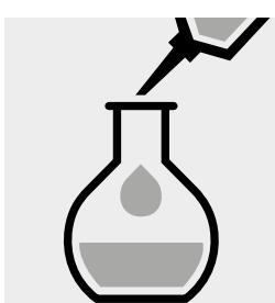
Messkolben bis zur Marke mit Isooctan für die Spektroskopie Uvasol® (Art. 1.04718) auffüllen und mischen.
