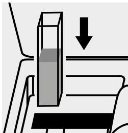
Küvette in den Küvetten- schacht einsetzen.
