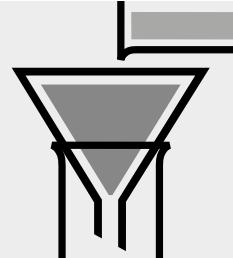
Bei Verunreinigungen Probe über ein Schnellfilterpapier filtrieren.
