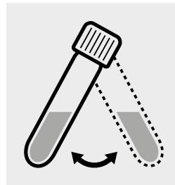
Küvette zum Lösen des Feststoffs umschwenken.
