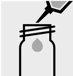
10 ml Probe in ein Testglas (Flachbodengläser, Art. 1.14902) pipettieren.
