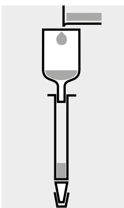
100 ml Probe und 6 Tropfen **AOX-4** einfüllen.
