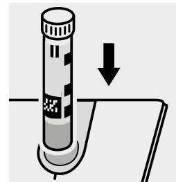
Küvette in den Küvetten-schacht einsetzen.
