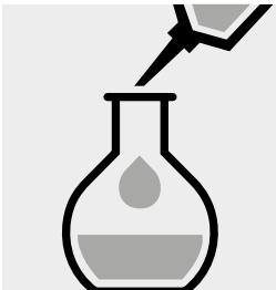
Messkolben mit dest. Wasser (empfohlen wird Art. 1.16754, Wasser zur Analyse EMSURE®) bis zur Marke auffüllen und gut mischen.
