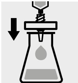
Probelösung durch Membranfilter Porenweite 0,45  $\mu\text{m}$  filtrieren.
