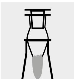
Absorber-Kerzen mit Glasstopfen verschließen und auf die Erlenmeyerkolben aufsetzen.
