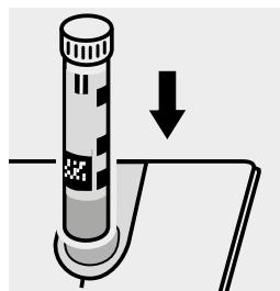
Küvette in den Küvetten- schacht einsetzen.
