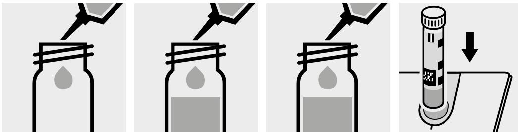
4,0 ml AC-1 in eine Rundküvette pipettieren.
