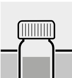
Gefäß im Wasserbad **genau** 10 Minuten bei  $95 \pm 5$  °C temperieren.
