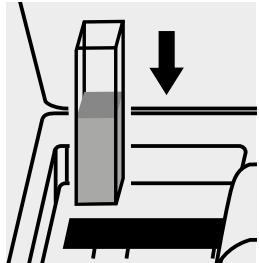
Küvette in den Küvetten- schacht einsetzen.
