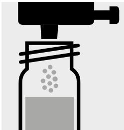
1 Dosis Fe-1K mit blauem Dosierer zugeben, mit Schraubkappe verschließen.
