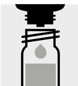
5 Tropfen P-2K zugeben, mit Schraubkappe verschließen und mischen.
