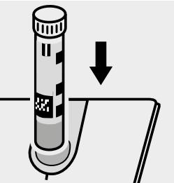
Küvette in den Küvetten- schacht einsetzen.
