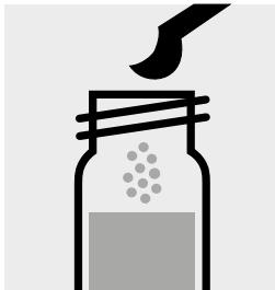
Zu beiden Küvetten je 1 gestrichen blauen Mikrolöffel F-1K zugeben, mit Schraubkappe verschließen.
