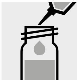
1,0 ml **Reagenz 1** mit Pipette zugeben. Mit Schraubkappe verschließen und mischen.
