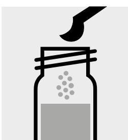
1 gestrichenen grauen Mikrolöffel Zn-5 zugeben, mit Schraubkappe verschließen und Feststoff lösen.
