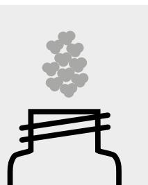
Etwa 2 g Probe auf 1 mg genau in eine DURAN®-Laborflasche einwiegen und gemäß §64 LFGB 06.00-8, Kapitel 7.1 [1] bearbeiten.
