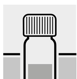
Glas im Wasserbad gemäß EN 1141 [1] bzw. §64 LFGB 31.00-7 [2] inkubieren.
