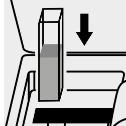
Küvette in den Küvetten-schacht einsetzen.
