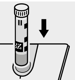
Küvette in den Küvetten- schacht einsetzen.
