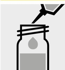
1,0 ml vorbereitete Probe in ein Glas mit Schraubverschluss pipettieren.
