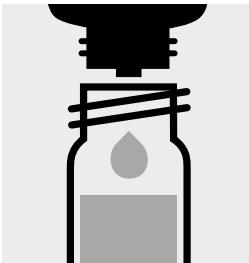
6 Tropfen **Sn-1K** in eine Reaktionsküvette geben, mit Schraubkappe verschließen und mischen.
