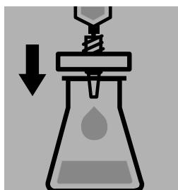
Extrakt **lichtgeschützt** über ein geeignetes Filter filtrieren.
