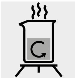
Probe bei 60 - 70 °C schmelzen und homogenisieren.
