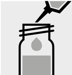
7,0 ml Probe mit Pipette in eine Reaktionsküvette zugeben, mit Schraubkappe verschließen und mischen.
