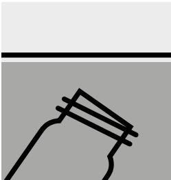
Reaktionsküvette luftblasenfrei (!) vollständig mit Wasserprobe füllen.
