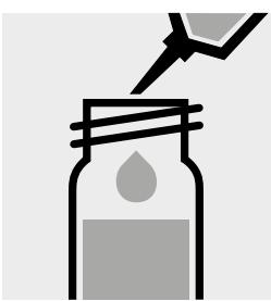
1,0 ml OA-4 mit Pipette zugeben, mit Schraubkappe verschließen und mischen.
