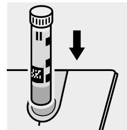
**Küvette  $\Sigma$  P** in den Küvettenschacht ein-setzen. Markierung auf der Küvette zu der am Photometer ausrichten. Messung wird automa-tisch durchgeführt.
