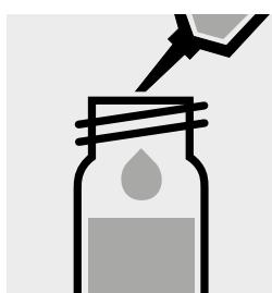
2,0 ml **Salzsäure 6 mol/l** mit Pipette zugeben, verschließen und mischen.
