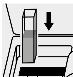
Küvette in den Küvetten-schacht einsetzen. Messung wird automatisch durchgeführt.
