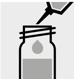
2,0 ml Probe **vorsichtig** in eine Reaktionsküvette pipettieren, mit Schraubkappe fest verschließen und kräftig mischen.
