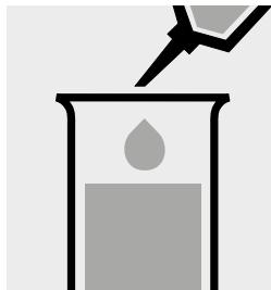
10 ml Probe mit Pipette zugeben und mischen.
