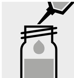
3,0 ml **abgericherte Blindprobe** vorsichtig in eine zweite Reaktionsküvette pipettieren, mit Schraubkappe fest verschließen und kräftig mischen.
