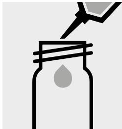
9,0 ml dest. Wasser mit Pipette zugeben (empfohlen wird Art. 1.16754, Wasser zur Analyse EMSURE®).
