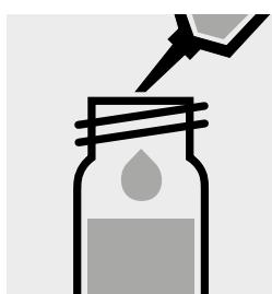
2,0 ml dest. Wasser (empfohlen wird Art. 1.16754, Wasser zur Analyse EMSURE®) in ein verschließbares Gefäß (20 ml) pipettieren.
