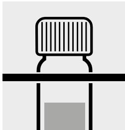
Küvette aus dem Thermoreaktor nehmen, im Reagenzglasgestell auf Raumtemperatur abkühlen lassen.
