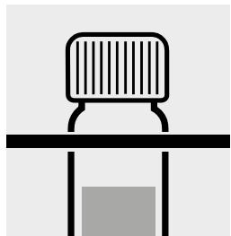
Küvette aus dem Thermoreaktor nehmen, im Reagenzglasgestell abkühlen lassen.
