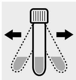
Küvette zum Lösen des Feststoffs kräftig schütteln und **1 Minute** stehen lassen.
