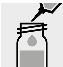
0,100 ml vorbereitete Probelösung (Filtrat) in ein Glas mit Schraubverschluss pipettieren.
