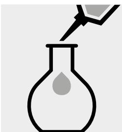
Probe im Verhältnis 1:200 (1+199) mit dest. Wasser (empfohlen wird Art. 1.16754, Wasser zur Analyse EMSURE®) verdünnen.
