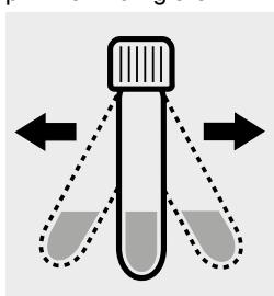
Küvette zum Lösen
