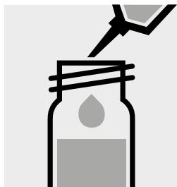
8,0 ml Probe mit Pipette zugeben und mit Schraubkappe verschließen.
