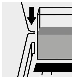
Küvette in den Küvetten- schacht einsetzen.
