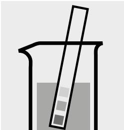
pH-Wert der Probe überprüfen, Soll-Bereich: pH 2–10. Falls erforderlich, tropfenweise mit verdünnter Natronlauge bzw. Schwefelsäure pH-Wert korrigieren.
