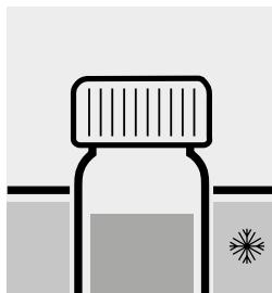
Gefäß im Eis-/Wasserbad **genau** 10 Minuten abkühlen.
