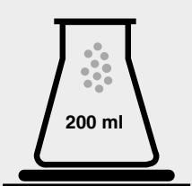
10 g vorbereitete Probe auf 1 mg genau in einen 200-ml-Erlenmeyer-Kolben einwiegen und Extraktion gemäß EN ISO 11052 [1] bzw. §64 LFGB 16.01-3 [2] durchführen:
