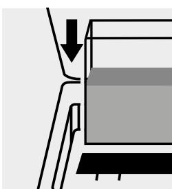
Proben-Küvette in den Küvettenschacht einsetzen.
