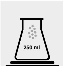
**50,0 ± 0,1 g homogenisierte Probe** in einen 250-ml-Erlenmeyerkolben einwiegen.
