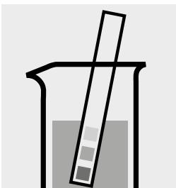
pH-Wert der Probe überprüfen, Soll-Bereich: pH 1 – 12. Falls erforderlich, tropfenweise mit verdünnter Schwefelsäure pH-Wert korrigieren.
