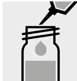
0,50 ml Probe mit Pipette zugeben, mit Schraubkappe verschließen und mischen.
