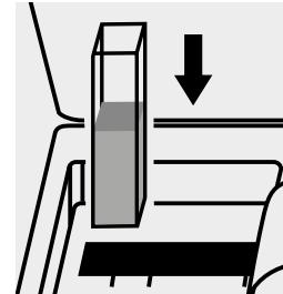
Küvette in den Küvetten-schacht einsetzen.
