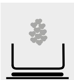
Probe auf 1 mg genau in ein geeignetes Gefäß einwiegen und eine Veraschung gemäß §64 LFGB 06.00-4 [3] durchführen.
