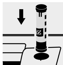
Mit AutoSelector Messbereich 2,0–75,0 mg/l NH<sub>4</sub>-N Methode wählen.
