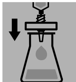
Extrakt **lichtgeschützt** über ein geeignetes Filter filtrieren.
