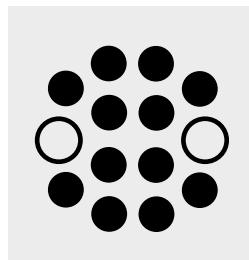
Beide Küvetten im Thermoreaktor 2 Stunden bei 148 °C erhitzen.
