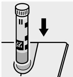
Küvette in den Küvetten- schacht einsetzen.
