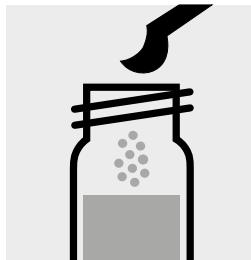
1 gestrichenen grünen Mikrolöffel Ph-2K zugeben, mit Schraubkappe verschließen.
