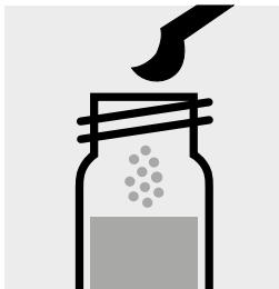
1 gestrichenen blauen Mikrolöffel CN-4 zugeben, mit Schraubkappe verschließen.
