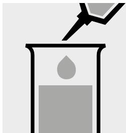
8,0 ml Probe mit Pipette zugeben und mischen.
