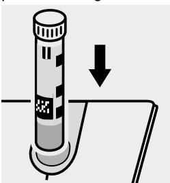
Küvette in den Küvetten- schacht einsetzen.
