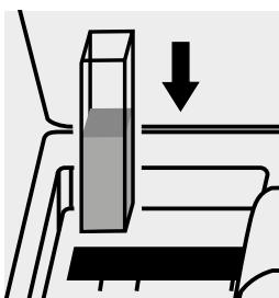
Küvette in den Küvetten- schacht einsetzen. Blindwertmessung wird automatisch durchgeführt.
