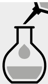
Messkolben bis zur Marke mit **Isooctan für die Spektroskopie Uvasol®** (Art. 1.04718) bzw. **Cyclohexan für die Spektroskopie Uvasol®** (Art. 1.02822) auffüllen und mischen.
