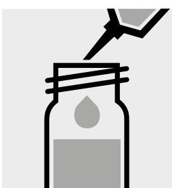
5,0 ml Zn-6 (Isobutylmethylketon, Art. 1.06146) mit Pipette zugeben und mit Schraubkappe verschließen.
