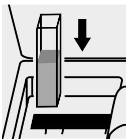
Küvette in den Küvetten- schacht einsetzen.
