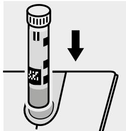
Küvette in den Küvetten- schacht einsetzen.
