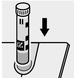
Küvette in den Küvetten- schacht einsetzen.
