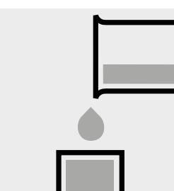
Lösung „Messprobe“ in die Küvette geben.
