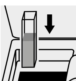
Küvette in den Küvetten-schacht einsetzen.
