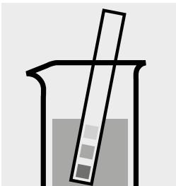
pH-Wert der Probe überprüfen, Soll-Bereich: pH 4,5 – 8,0. Falls erforderlich, tropfenweise mit verdünnter Natronlauge bzw. Schwefelsäure pH-Wert korrigieren.
