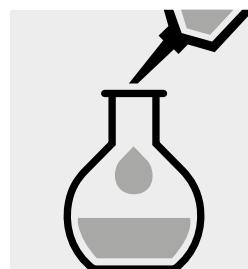
Messkolben mit dest. Wasser (empfohlen wird Art. 1.16754, Wasser zur Analyse EMSURE®) bis zur Marke auffüllen und gut mischen.
