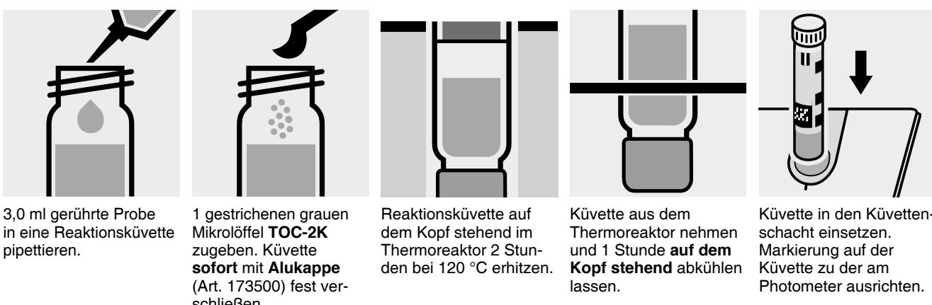
3,0 ml gerührte Probe in eine Reaktionsküvette pipettieren.
