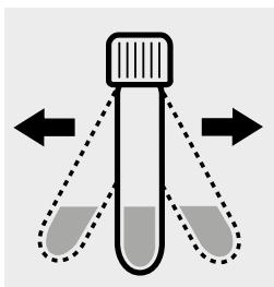
Küvette fest verschließen und **kräftig** schütteln, bis das Reagenz vollständig gelöst ist.
