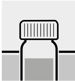
Gefäß im Wasserbad **genau** 10 Minuten bei  $95 \pm 5$  °C temperieren.
