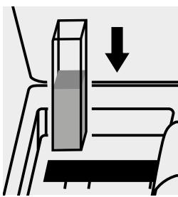
Küvette in den Küvetten- schacht einsetzen.
