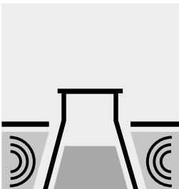
Enthält die Probe Luft- oder Gasblasen: im Ultraschall-Bad entgasen.
