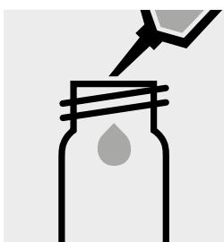
10 ml Probe in eine leere Rundküvette (Leerküvetten, Art. 114724) pipettieren.
