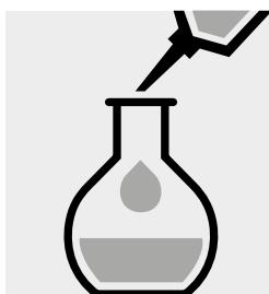
Messkolben mit dest. Wasser (empfohlen wird Art. 1.16754, Wasser zur Analyse EMSURE<sup>®</sup>) bis zur Marke auffüllen und gut mischen.
