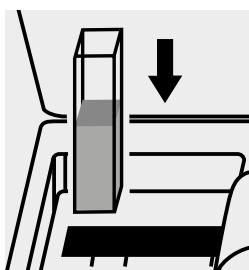
Küvette in den Küvetten- schacht einsetzen.
