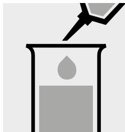
0,50 ml Probe mit Pipette zugeben und mischen.
