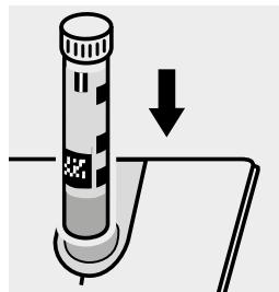
Küvette in den Küvetten- schacht einsetzen.
