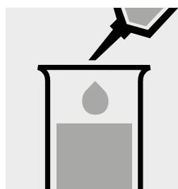
2 ml vorbereitete Probelösung mit 8 ml **Reagenzlösung** mischen: **Messprobe**.
