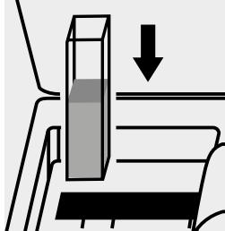
Küvette in den Küvetten- schacht einsetzen.
