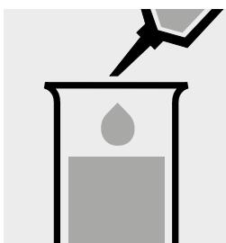
5,0 ml dest. Wasser (empfohlen wird Art. 1.16754, Wasser zur Analyse EMSURE®) in ein Reagenzglas pipettieren.
