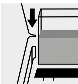
Proben-Küvette in den Küvettenschacht einsetzen.
