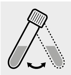
Bodensatz in der Küvette durch Umschwenken in Schweben bringen.
