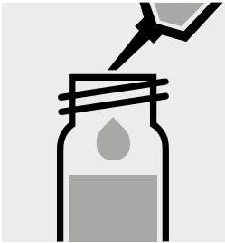
2,0 ml vorbereitete Probe in ein verschließbares Gefäß (20 ml) pipettieren.
