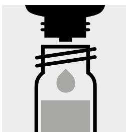
3 Tropfen CN-2 zugeben, mit Schraubkappe verschließen und mischen:
