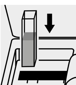
Küvette in den Küvetten- schacht einsetzen.
