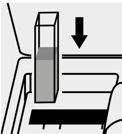
Küvette in den Küvetten-schacht einsetzen.
