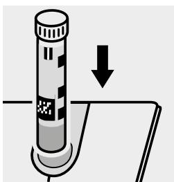
Küvette in den Küvetten- schacht einsetzen.
