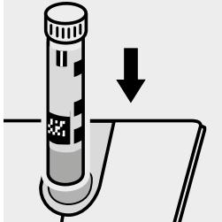
Küvette in den Küvetten- schacht einsetzen.
