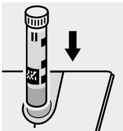
Proben-Küvette in den Küvettenschacht einsetzen. Markierung auf der Küvette zu der am Photometer ausrichten.
