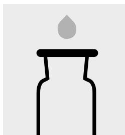
2 Sauerstoff-Reaktionsflaschen mit **angeimpfter Nährsalzlösung** und 2 Glasperlen bis zum Überlauf füllen. Mit angeschrägtem Glasstopfen luftblasenfrei verschließen.
